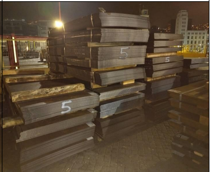
24. Vista del acopio de planchas calientes con mas de 6 de alto.
