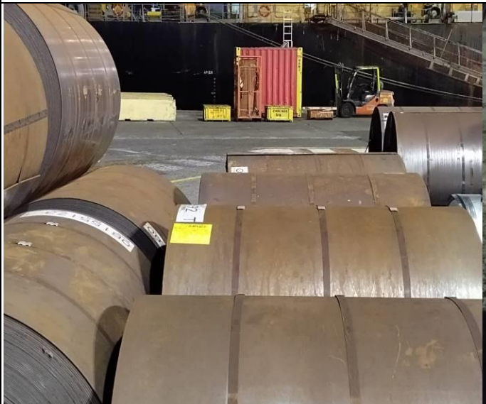
11. Bobina caliente sin daños observables.
