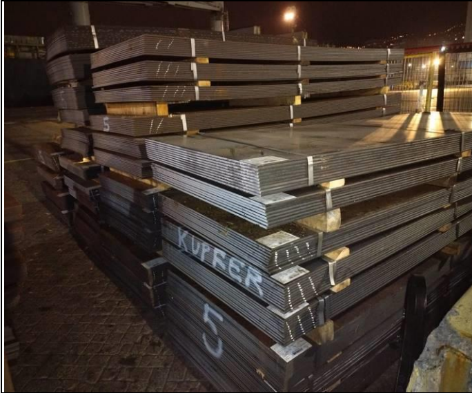
21. Vista de las esquinas de las planchas calientes sin daños observables.
