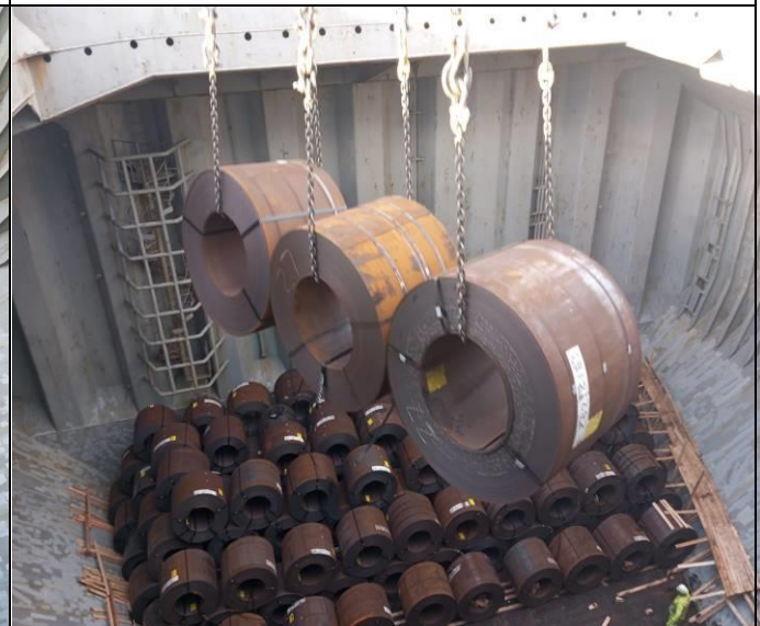
4. Descarga de alambres con uso de grúa de muelle. Bodega Nr. 1
