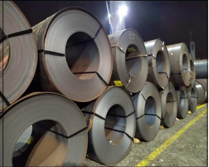
14. Bobina caliente sin daños observables.
