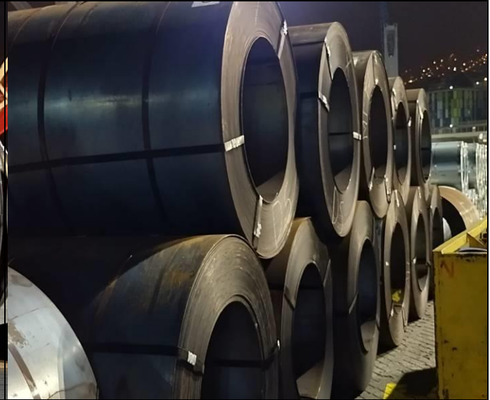
10. Bobina caliente sin daños observables.
