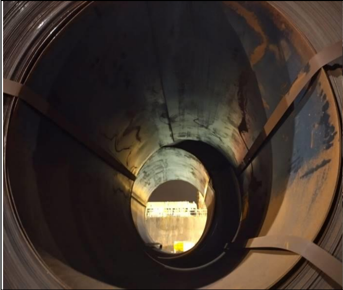
13. Bobina caliente sin daños observables.
