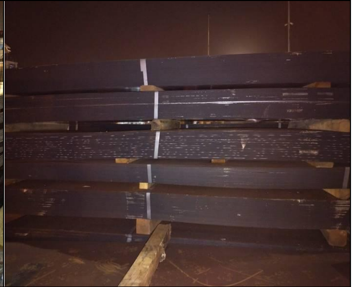
22. Vista lateral de planchas calientes sin daños observables.
