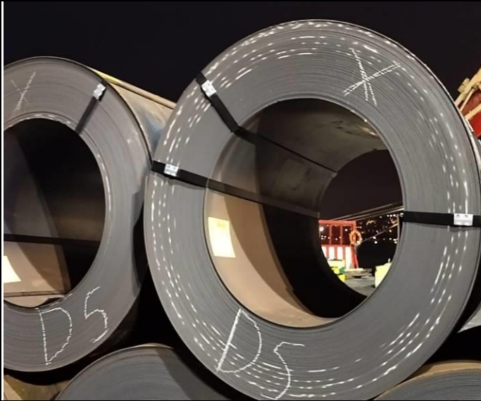
9. Bobina caliente sin daños observables.
