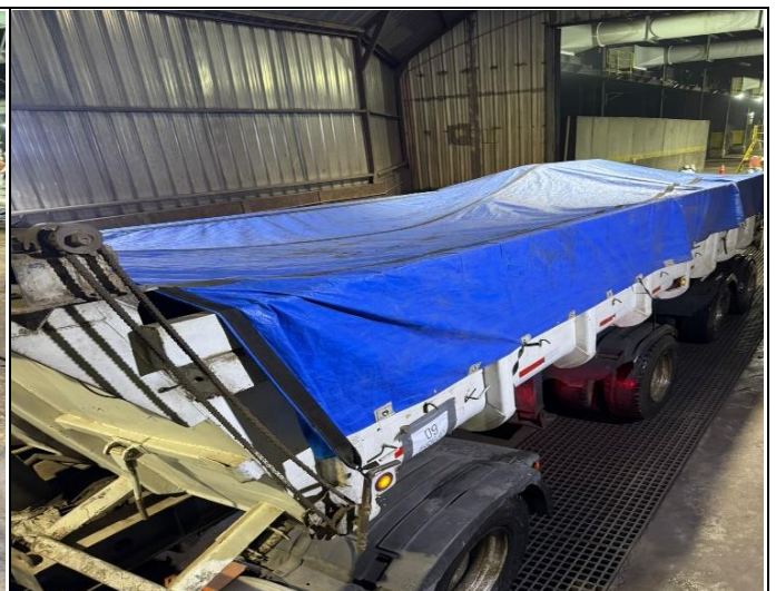
2. Correcto encarpado de las tolvas antes de su despacho.
