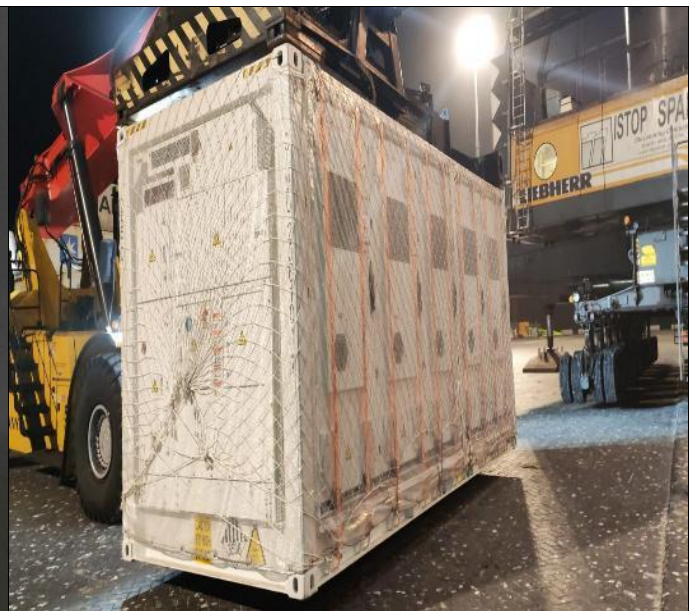
28. Vista de portacontenedor manipulando batería.
