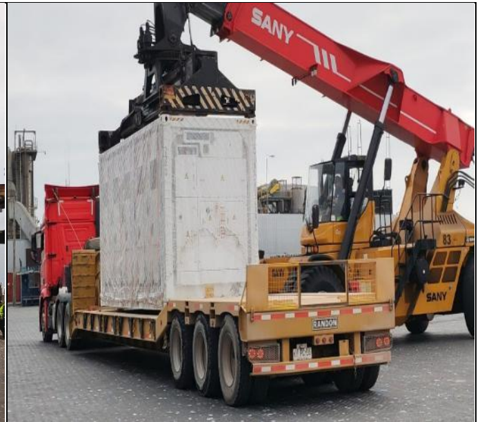
18. Portacontenedor cargando batería a camión, para ser trasladada a lugar de acopio.
