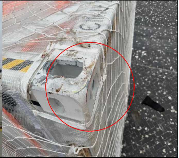
40. Corner Fitting rayado.
