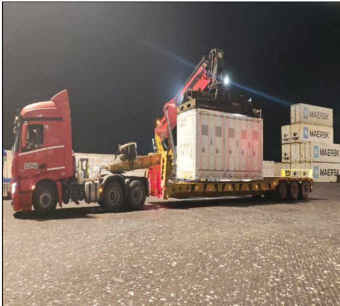
25. Portacontenedor cargando batería a camión, para ser trasladada a lugar de acopio.
