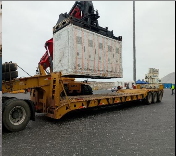
38. Batería siendo posicionada sobre camión.
