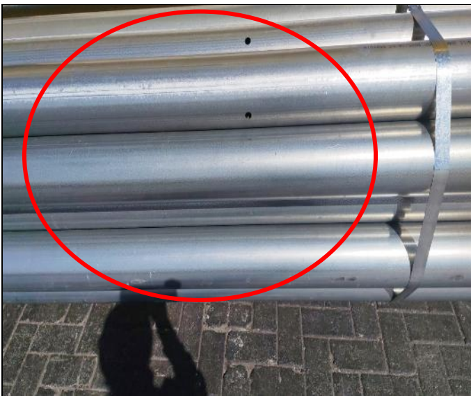
15.- Carga rayada, condición de arribo.
