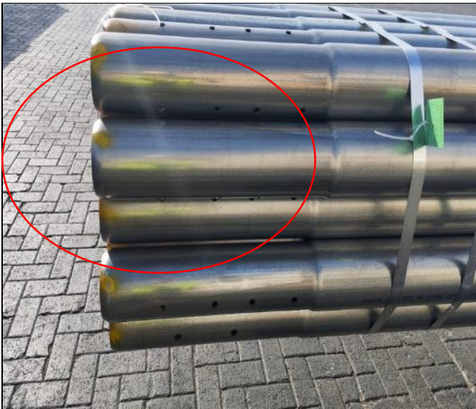
39.- Carga rayada, condición de arribo.
