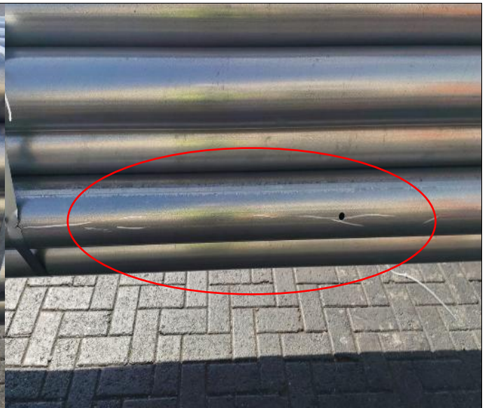
40.- Carga rayada, condición de arribo.
