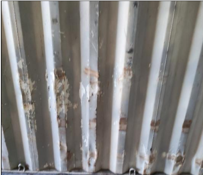
17.- Panel lateral izquierdo del contenedor abollado.
