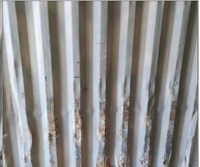
18.- Panel lateral derecho del contenedor abollado.
