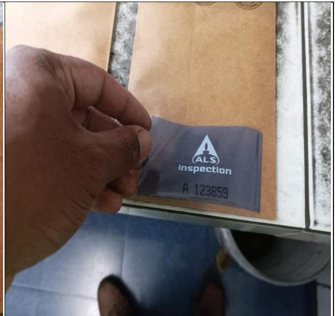
45. Sample bags being sealed with ALS tape by ALS Surveyor.
