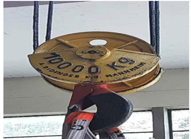
6.- Capacidad en trocola gancho auxiliar 10 ton.
