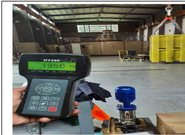
9.- Registro de peso levantado.
