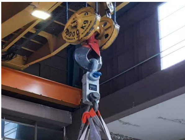
7.- Dinamómetro instalado para registro de carga aplicada.
