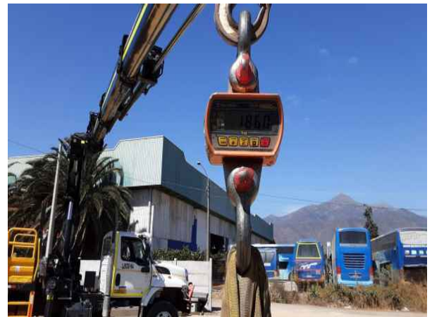
8.- Registro prueba de carga.
