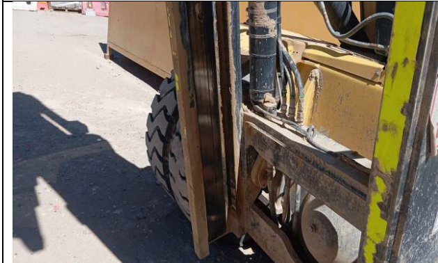
9.- Guías de levante del bastidor de la grúa en buen estado.
