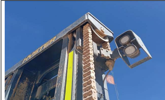
7.- Cadena de levante en buen estado.
