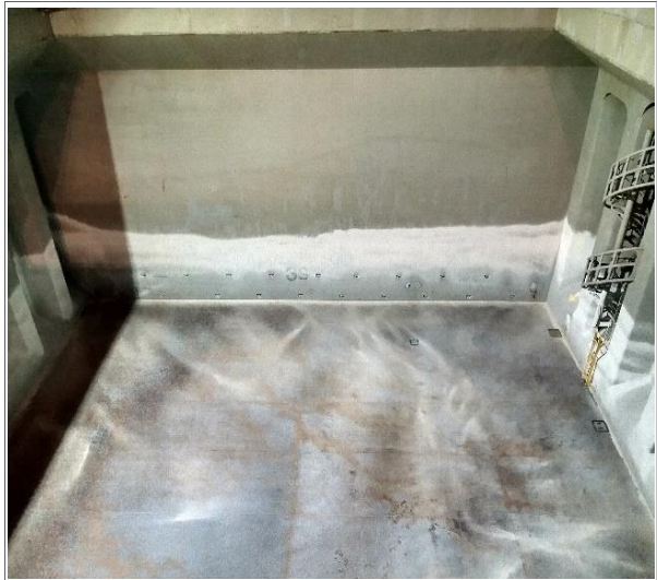
30. Banda de estribor correctamente encalada.
