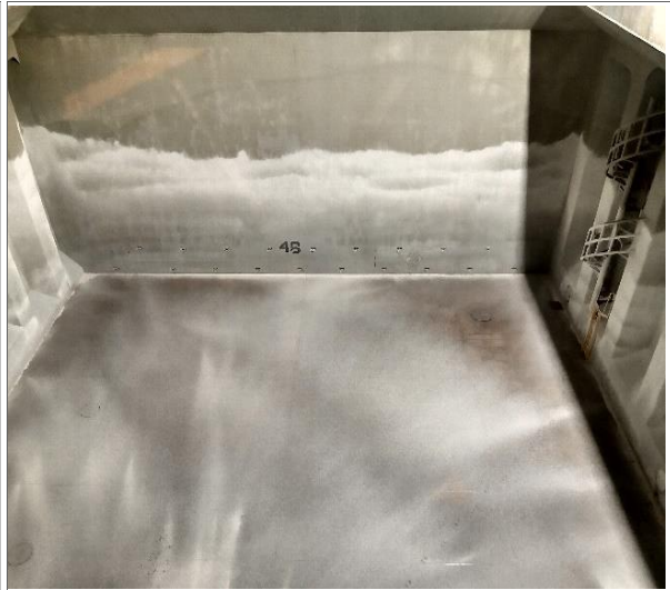
34. Banda de estribor correctamente encalada.
