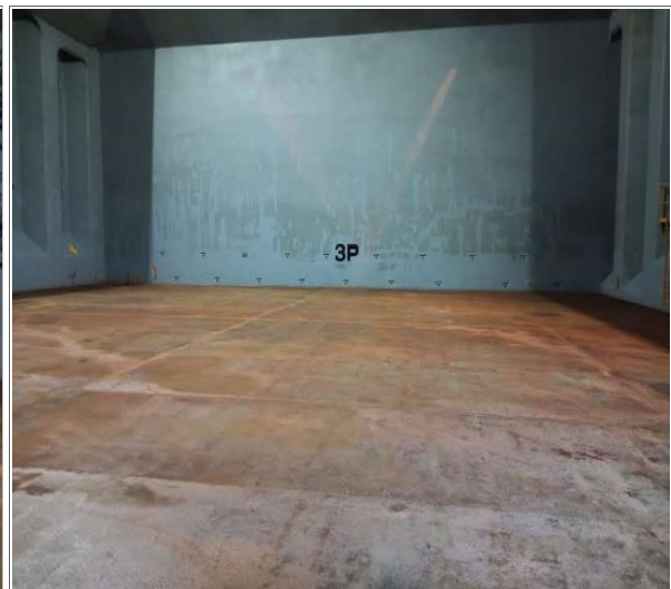
12. Banda de babor en condiciones de encalar.
