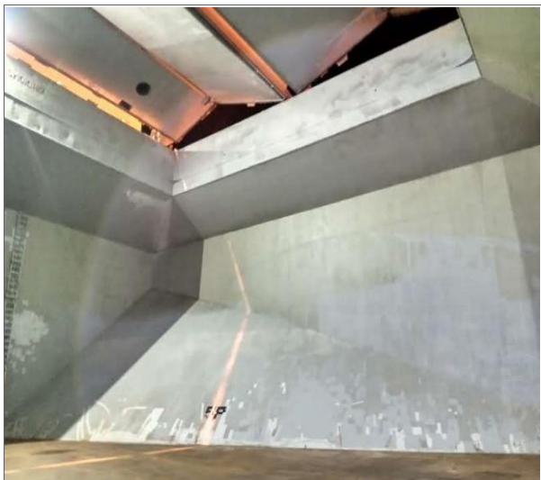
20. Banda de babor en condiciones de encalar.
