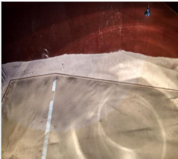
19. Banda de babor recubierta con película de cal.
