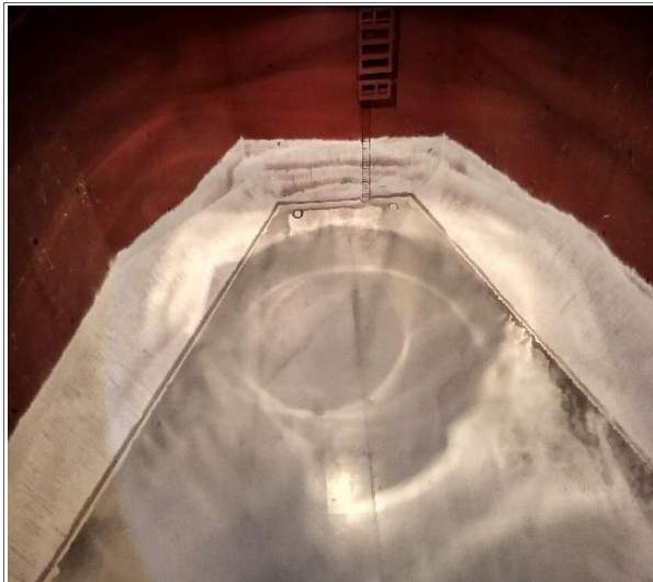
17. Vista a proa de la bodega N° 1 con recubierta con cal.
