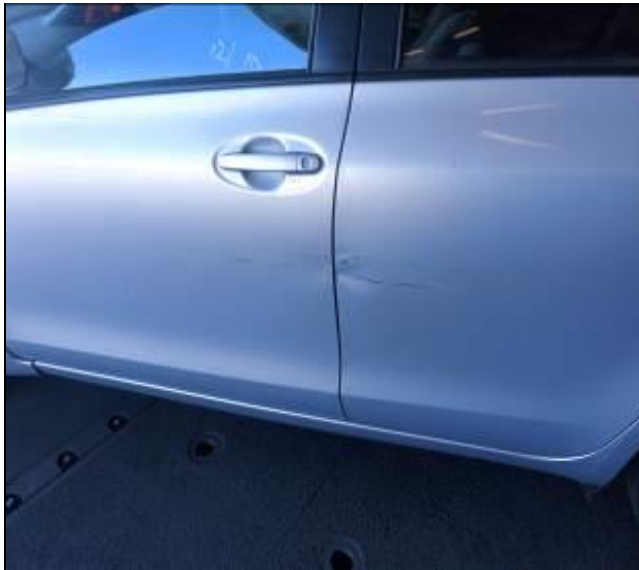
13. Vehículo usado abollado en puertas izquierda delantera y trasera.
