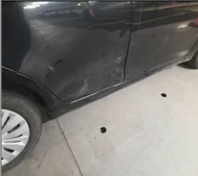
21. Vehículo usado con puerta trasera derecha abollada.
