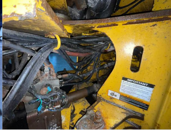
35. Mangueras hidráulicas en orden.
