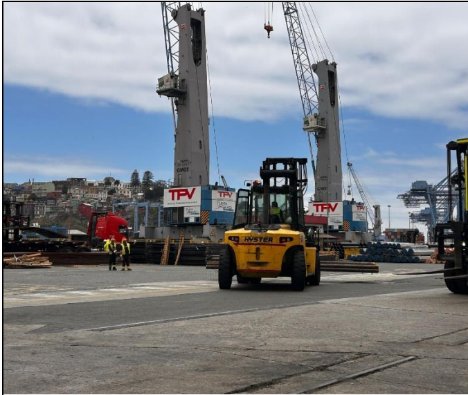
41. Grúa horquilla trasladando macizos al sector de acopio.
