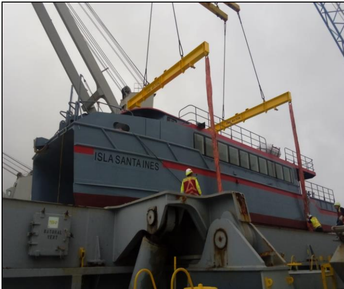
17. Instalación de maniobras de izaje, para la descarga de Passenger boat.
