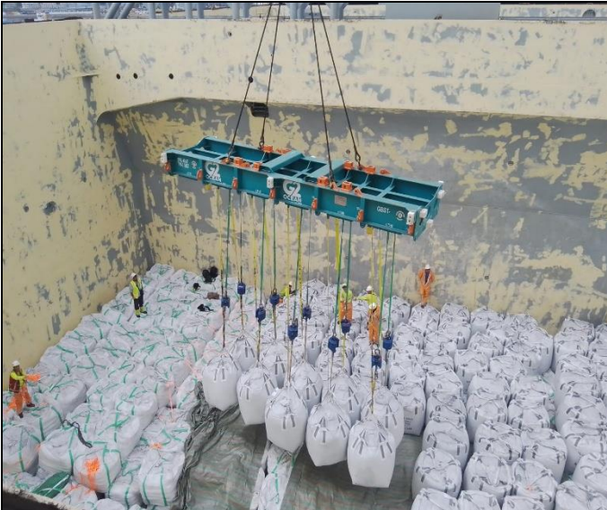
21. Sacos siendo descargados desde H1, con uso de grúa Gottwald.
