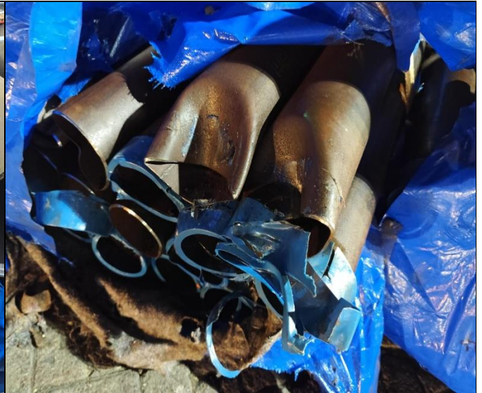
50. Paquetería de tubos abollados. Industria Metalúrgica Limitada BL: GSSWPAW31174A.
