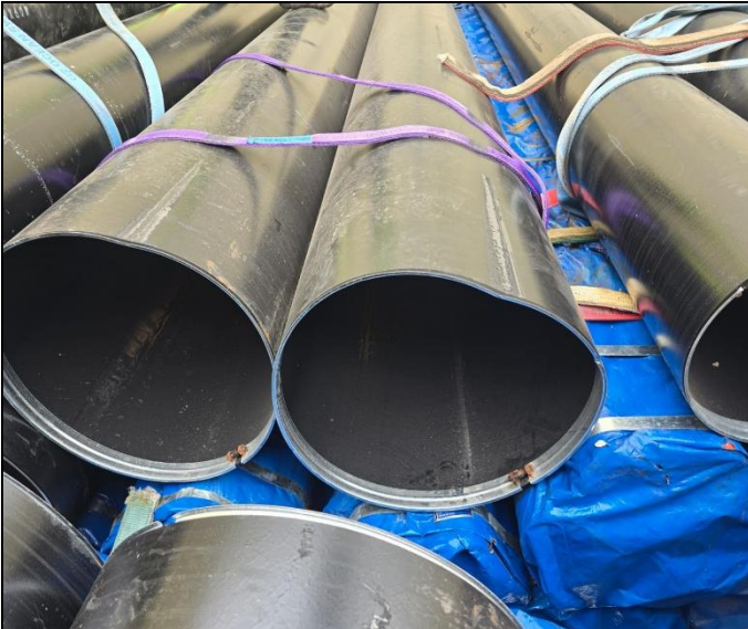
49. Tubería abollada desde H2. Multiaceros SA -BL: GSSWPAW31168A.
