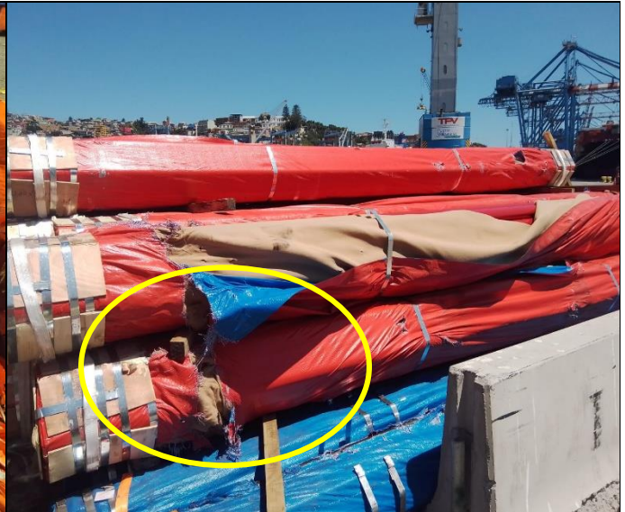
54. Paquete de tubos con envoltorio externo rasgado. Multiaceros SA BL: GSSWPAW31168.
