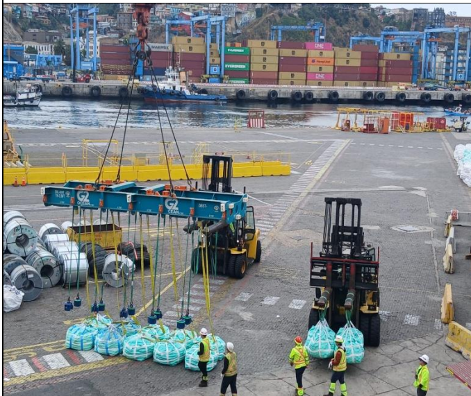
27. Operación de descarga de maxisacos en simultaneo.
