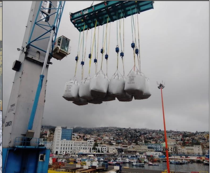
22. Operación de descarga de 10 maxisacos en simultaneo.
