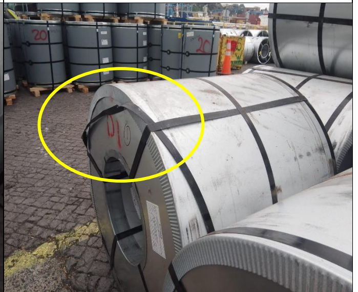
60. Zuncho suelto en bobina galvanizada. BL: GSSWPAW31172A.
