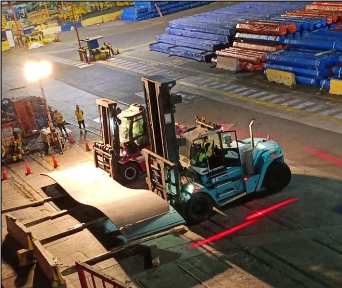
33. Plancha caliente siendo trasladado por dos grúas horquillas.
