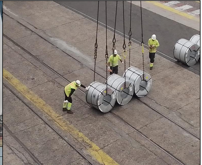
46. Estibadores posicionando cuñas de madera a bobinas posicionadas en muelle.
