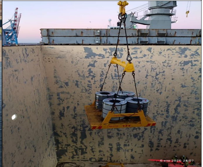
36. Bobinas paletizadas siendo descargadas desde H4.
