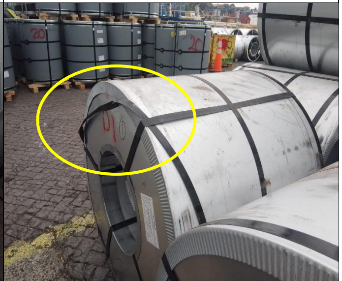
60. Zuncho suelto en bobina galvanizada. BL: GSSWPAW31172A.
