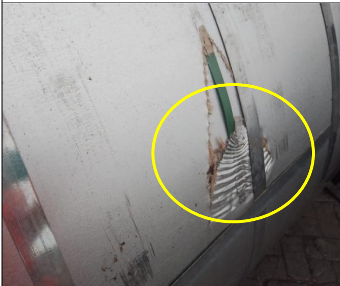
59. Protección externa de bobina rasgada. BL: GSSWPAW31172A.
