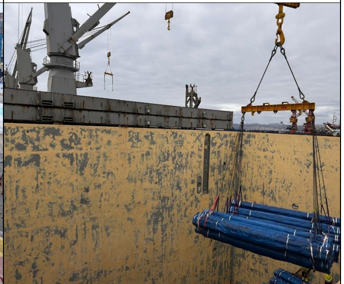
28. Descarga de paquetería de tubos desde H5.
