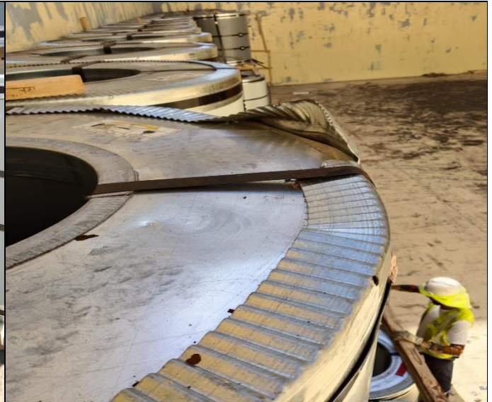
58. Protección del borde externo de bobina paletizada rota. Cintac S.A.I.C BL: GSSWPAW31157A.
