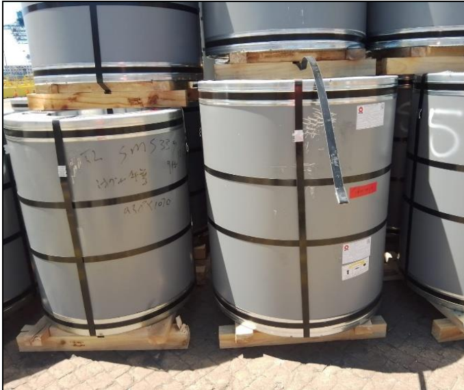
57. Zuncho cortado de bobina paletizada. Cintac S.A.I.C - BL: GSSWPAW31157A.
