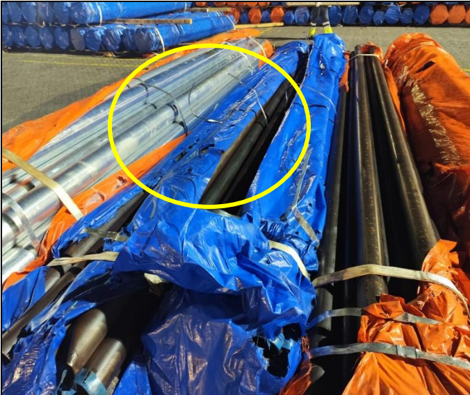
53. Paquete de tubos con zunchos cortados. Multiaceros SA.- BL: GSSWPAW31168.
