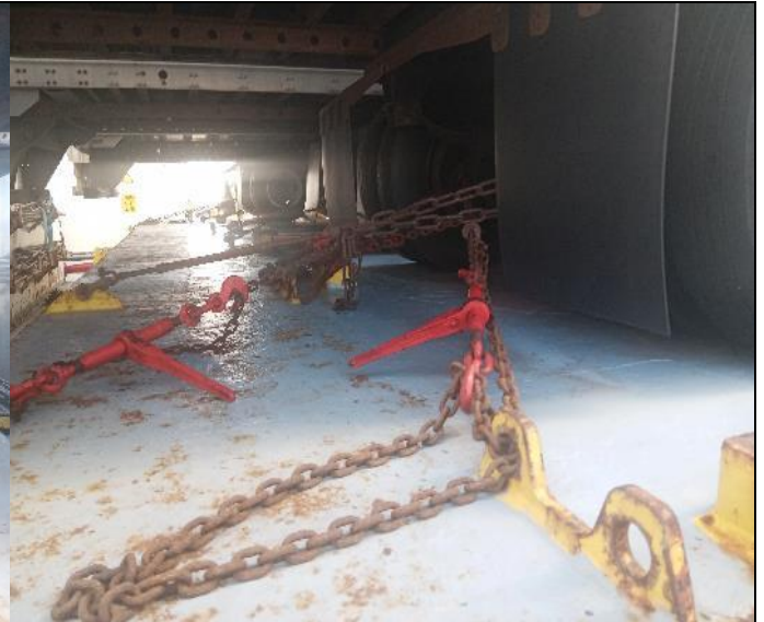
6. Cadenas utilizadas en la trinca de los trailers, condición de arribo.
