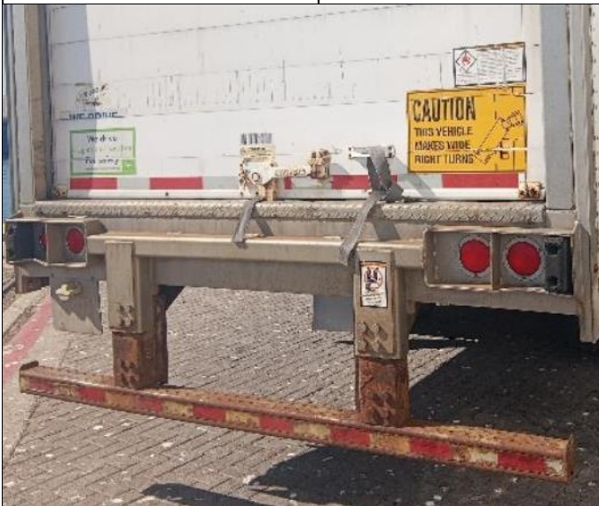
47. Parachoques con oxidación.
