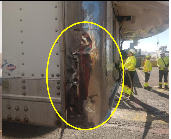
24. Abolladura en el borde izquierdo del panel frontal.
