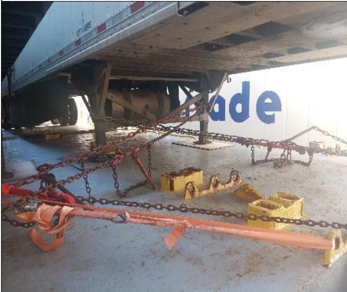
7. Cadenas utilizadas en la trinca de los trailers, condición de arribo.
