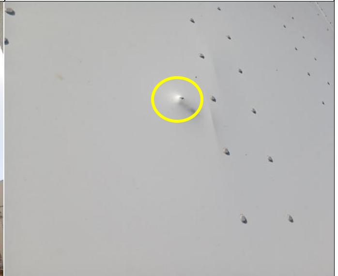
40. Abolladura en el panel lateral izquierdo.
