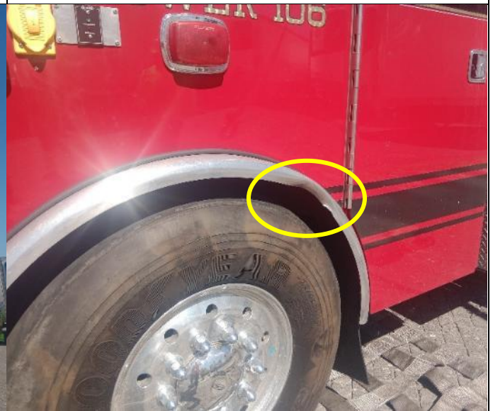
64. Abolladura en el tapabarro delantero derecho, daño ocasionado por los estibadores.
