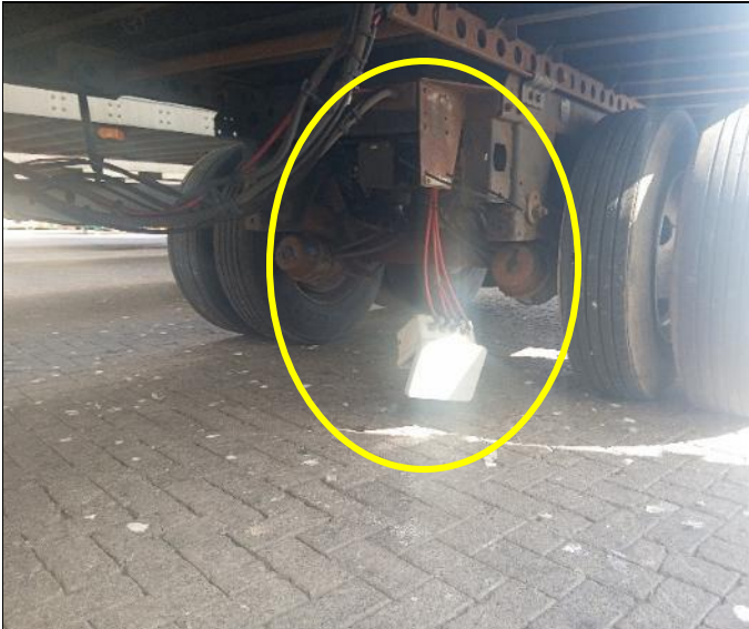
25. Caja de conexiones posterior del camión caída.
