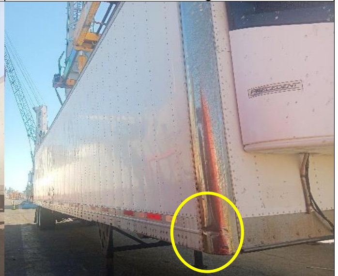
20. Abolladura en el borde izquierdo del panel frontal.
