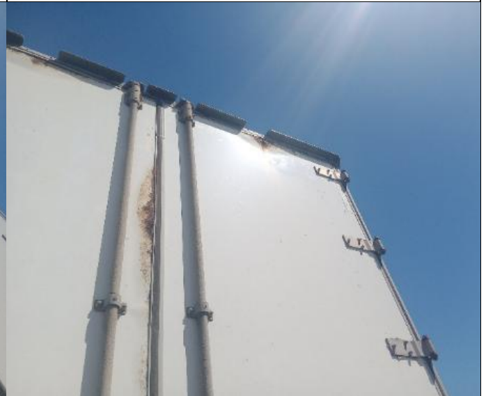
80. Puerta derecha abollada en la zona superior y con presencia de oxidación.
