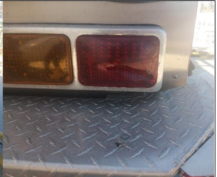
62. luz direccional zona trasera lado izquierdo rota (color rojo). Condición de arribo.
