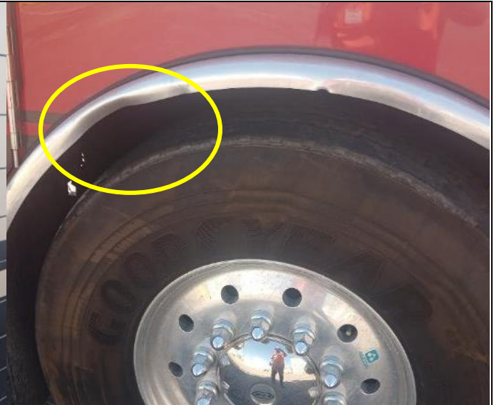
66. Tapabarro delantero izquierdo abollado, daño ocasionado por los estibadores.
