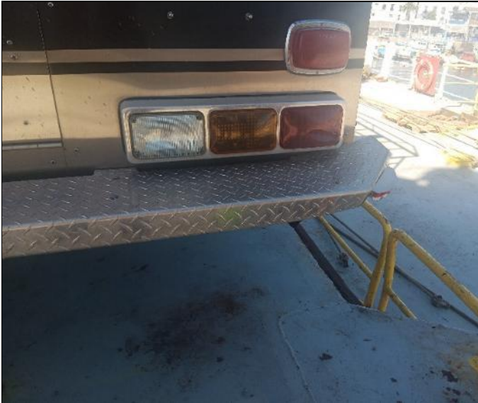
61. Esquina izquierda del parachoques trasero abollado, condición de arribo.
