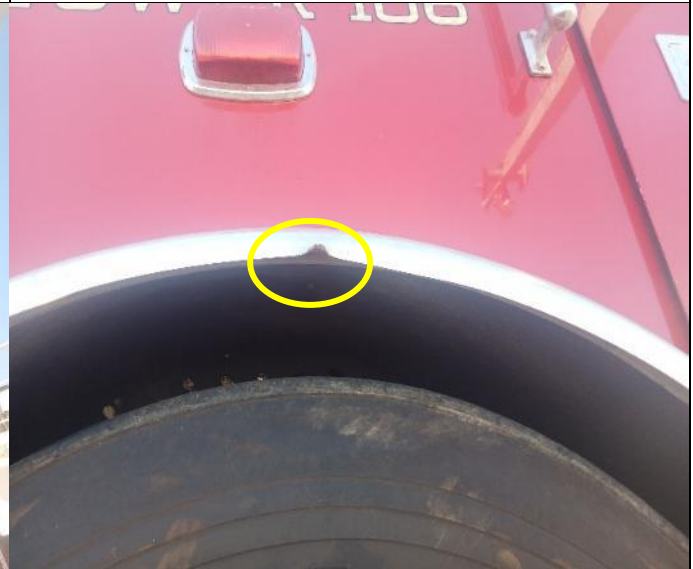
60. Abolladura en tapabarro delantero izquierdo, condición de arribo.
