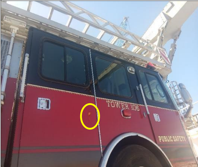
59. Ventanas en buenas condiciones. Pintura de la puerta izquierda trasera (pasajeros) rayada, condición de arribo.
