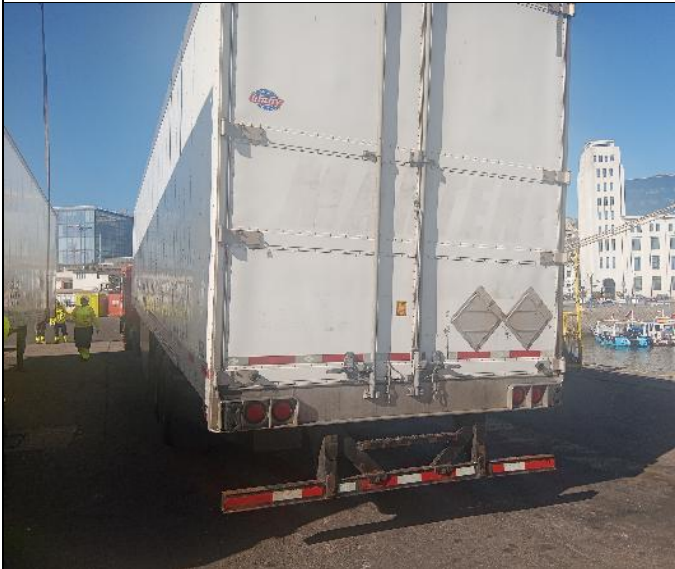
15. Presencia de oxidación en el parachoques.
