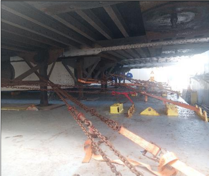
5. Cadenas utilizadas en la trinca de los trailers, condición de arribo.
