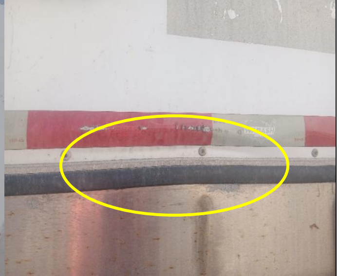
56. Puerta derecha abollada en su base.
