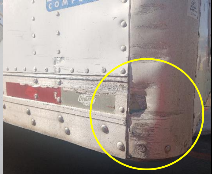
28. Borde izquierdo del panel frontal abollado y rayado.
