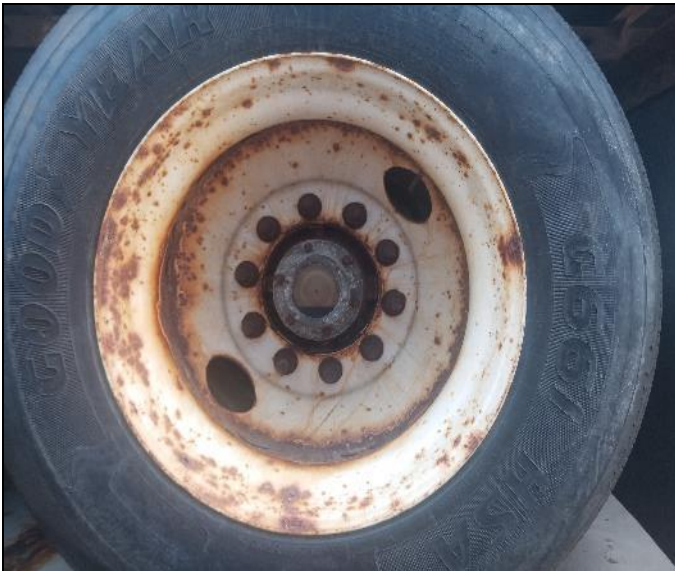
9. Ring/ aros con presencia de oxidación, condición de arriba.
