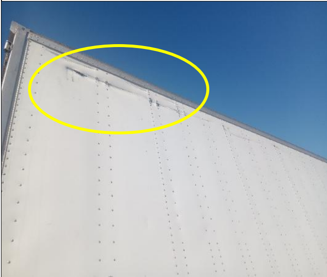
31. Panel lateral izquierdo con rayaduras en la pintura y abollado.
