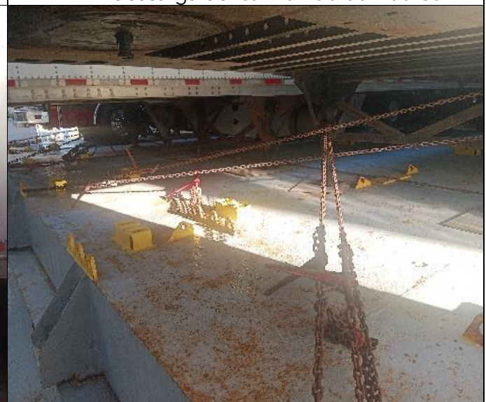
4. Cadenas utilizadas en la trunca de los trailers, condición de arribo.
