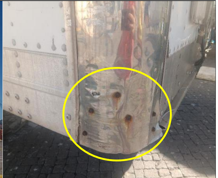
54. Abolladura en el borde del panel frontal izquierdo.
