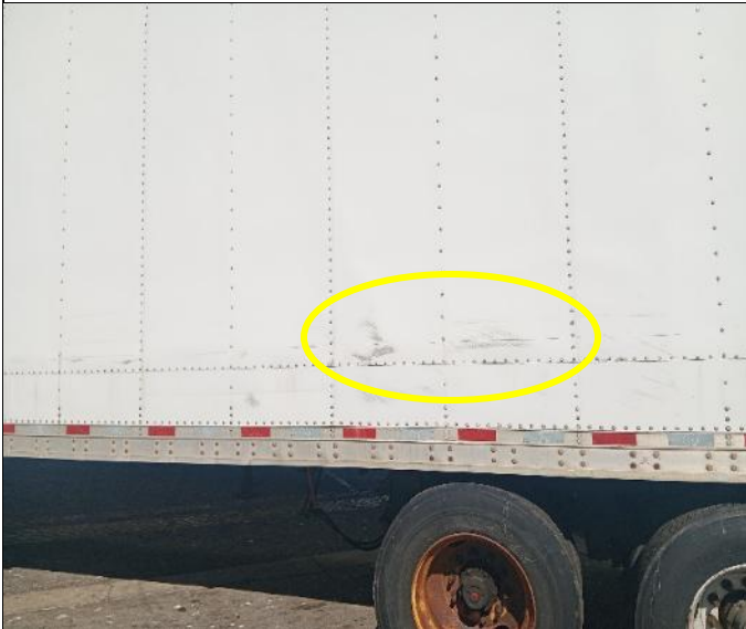
51. Pintura rayada en panel lateral derecho.
