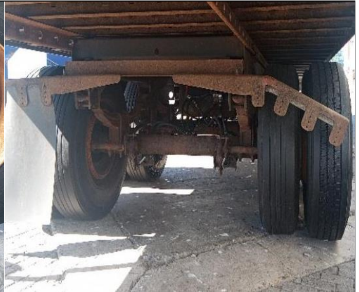
50. Tapabarro doblado y oxidado, sin la goma del tapabarras
