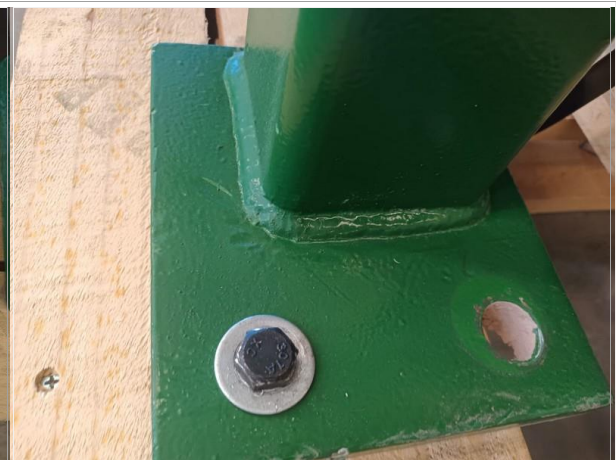
78. Vista de la sujeción en la base de la carga.
