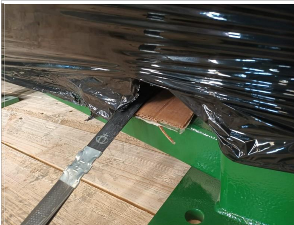
27. Cubre cantos entre los zunchos metálicos y la carga.
