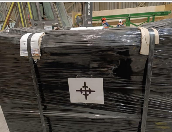
75. Cubre cantos entre los zunchos metálicos y la carga.
