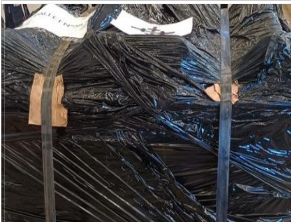
151. Cubre cantos entre los zunchos metálicos y la carga.
