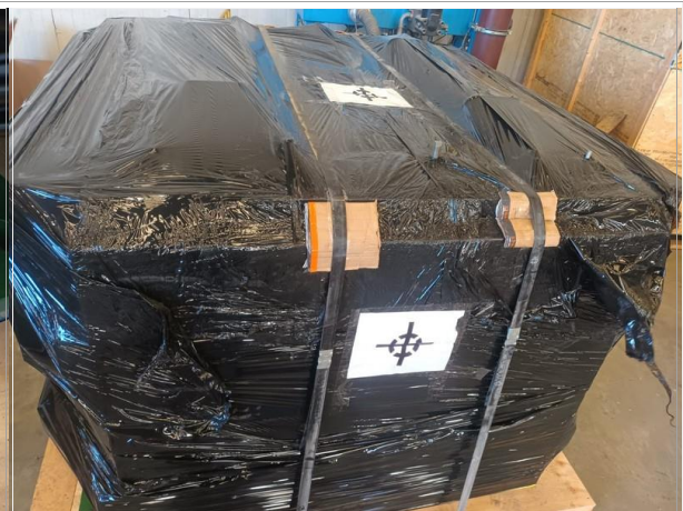
16. Carga con la sujeción de zunchos metálicos al pallet.
