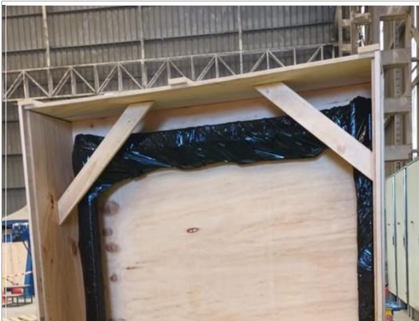
59. Vista de la madera dispuesta para evitar el desplazamiento.
