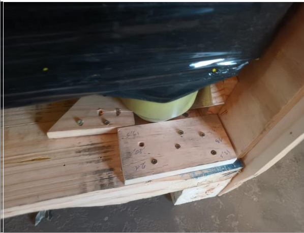
37. Vista de la madera con sujeción en la base para evitar desplazamientos.
