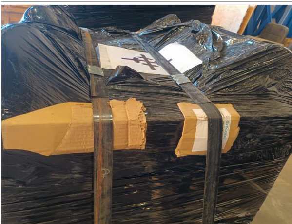
155. Cubre cantos entre los zunchos metálicos y la carga.
