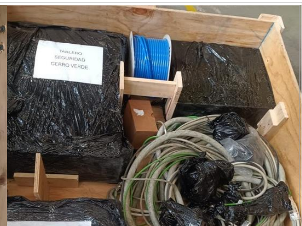
168. Vista de la madera dispuesta para evitar desplazamientos.
