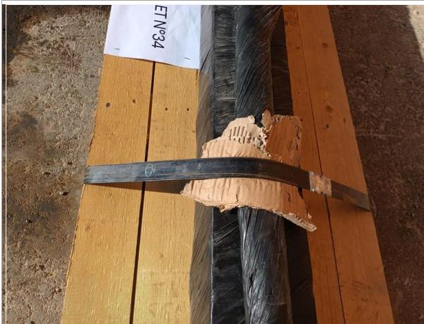
147. Cubre cantos entre los zunchos metálicos y la carga.
