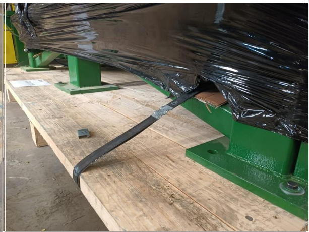
26. Carga con la sujeción de zunchos metálicos al pallet.
