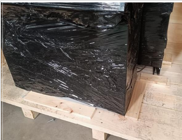
159. Vista de la madera dispuesta para evitar desplazamientos.
