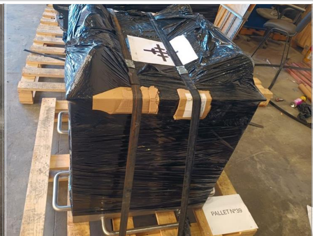
154. Vista de la carga con la sujeción de zunchos metálicos al pallet.
