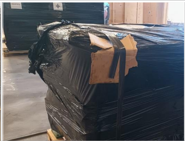
22. Cubre cantos entre los zunchos metálicos y la carga.
