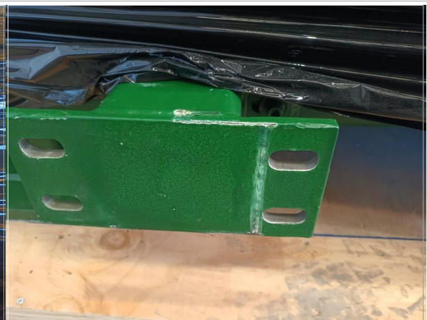
14. Raspaduras en la pintura.
