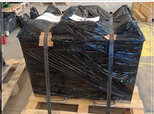
150. Vista de la carga con la sujeción de zunchos metálicos al pallet.
