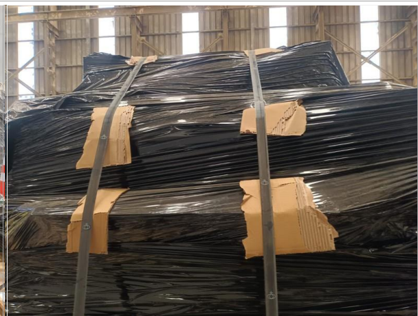
84. Cubre cantos entre los zunchos metálicos y la carga.
