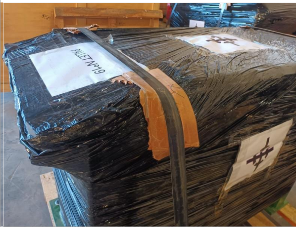
89. Cubre cantos entre los zunchos metálicos y la carga.
