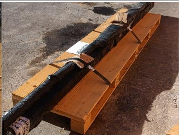
146. Vista de la carga con la sujeción de zunchos metálicos al pallet.
