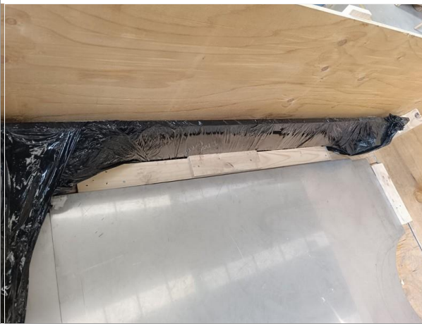
43. Vista de la madera con sujeción en la base para evitar desplazamientos.
