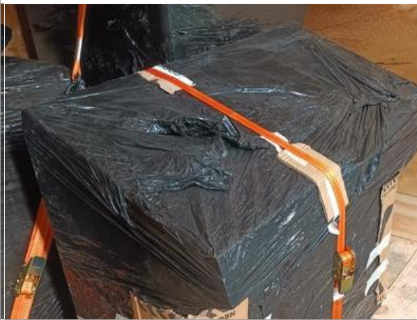
161. Cubre cantos entre las eslingas de polipropileno y la carga.
