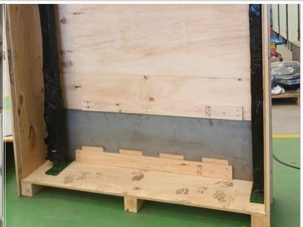
60. Vista de la madera dispuesta para evitar el desplazamiento.
