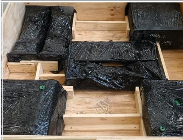
165. Vista de la madera dispuesta para evitar desplazamientos.
