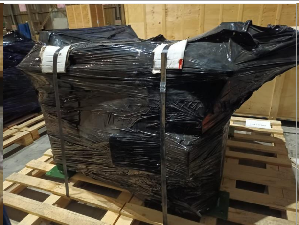
10. Vista de la carga con la sujeción de zunchos metálicos al pallet.
