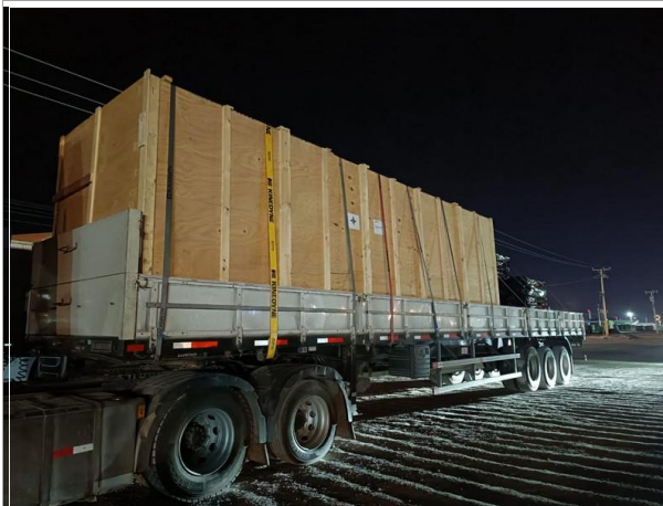
197. Vista de la trinca en Camión N°4.
