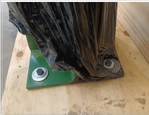
101. Vista de la sujeción en la base de la carga.
