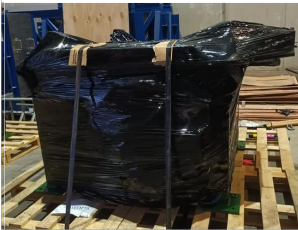
69. Vista de la carga con la sujeción de zunchos metálicos al pallet.
