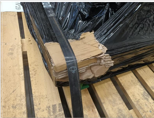
129. Cubre cantos entre los zunchos metálicos y la carga.
