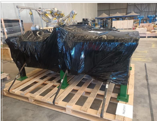
79. Vista de la carga con la sujeción de zunchos metálicos al pallet.
