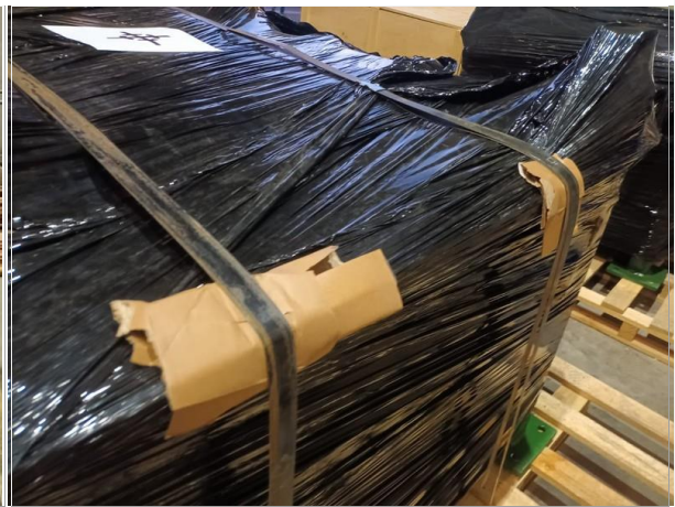
70. Cubre cantos entre los zunchos metálicos y la carga.
