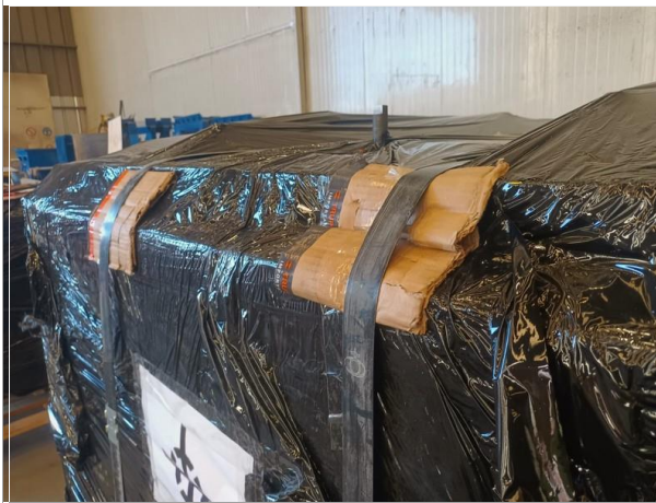
17. Cubre cantos entre los zunchos metálicos y la carga.
