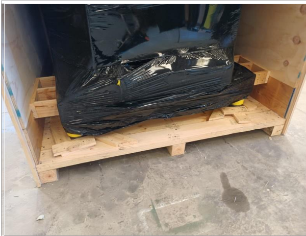
93. Vista de la madera dispuesta para evitar desplazamientos.
