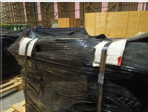
11. Vista de cubre cantos entre los zunchos metálicos y la carga.
