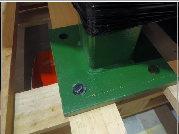
68. Vista de la sujeción en la base de la carga.
