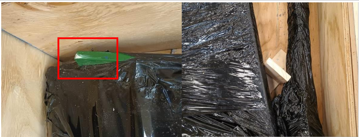
50. Vista de la madera con sujeción en la base para evitar desplazamientos.
