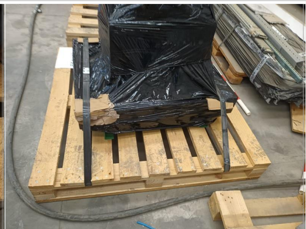
128. Vista de la carga con la sujeción de zunchos metálicos al pallet.
