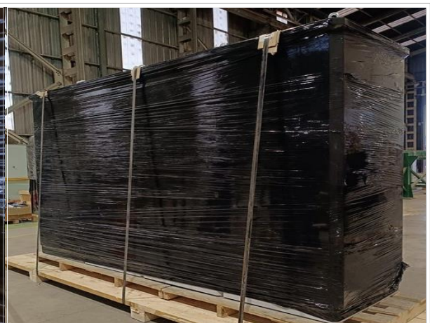
132. Vista de la carga con la sujeción de zunchos metálicos al pallet.
