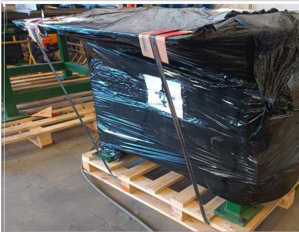
21. Vista de la carga con la sujeción de zunchos metálicos al pallet.
