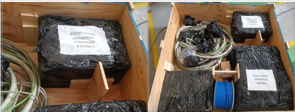
169. Vista de la madera dispuesta para evitar desplazamientos.
