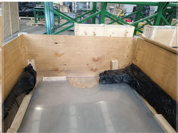
44. Vista de la madera con sujeción en la base para evitar desplazamientos.
