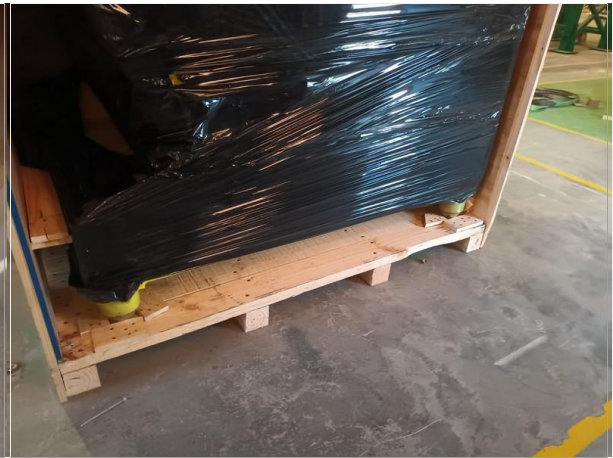
38. Vista general de la madera dispuesta para evitar desplazamientos.
