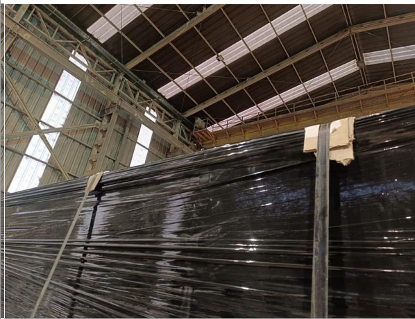
133. Cubre cantos entre los zunchos metálicos y la carga.
