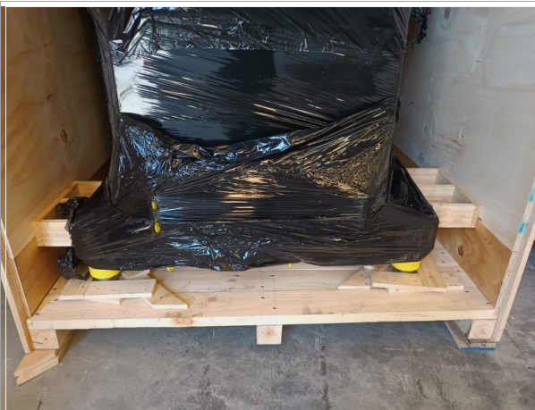
107. Vista de la madera dispuesta para evitar desplazamientos.
