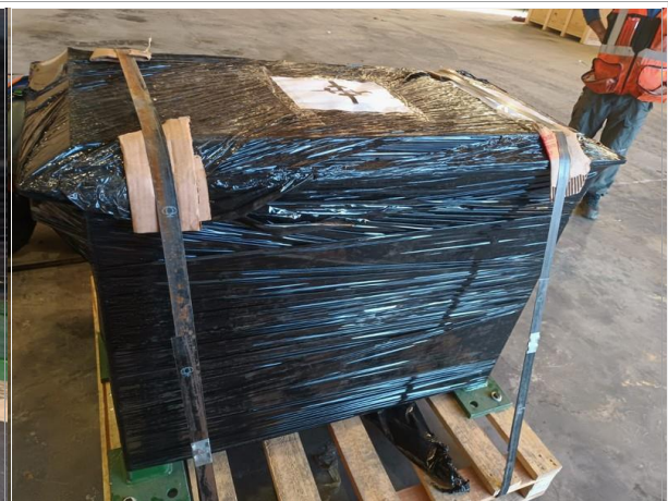
88. Vista de la carga con la sujeción de zunchos metálicos al pallet.
