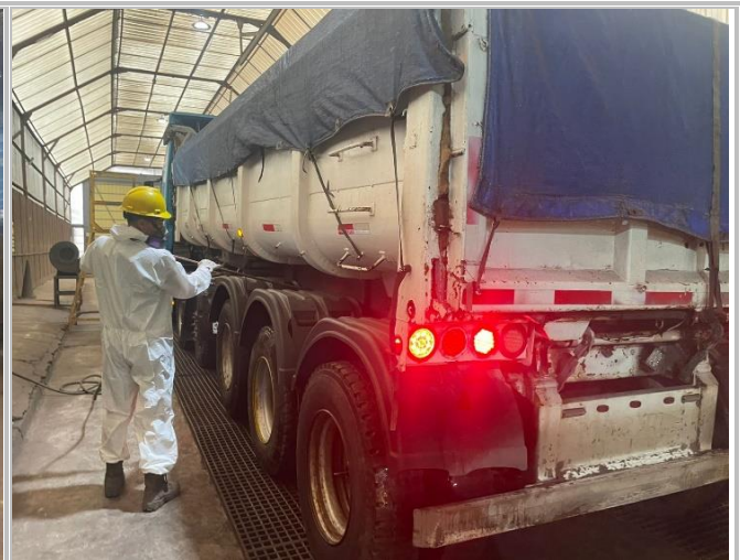
2. Vista general del correcto encarpado de las tolvas antes de su despacho.
