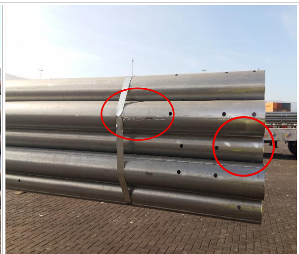
12. Otra vista de la tubería rayada.
