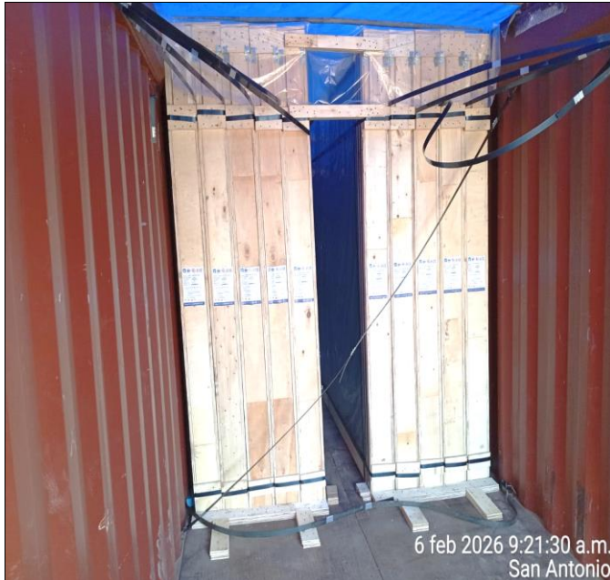
5.- 5 jabas de madera conteniendo vidrios, estibadas de forma semi diagonal (costado izquierdo) y 5 jabas de madera conteniendo vidrios, estibadas de forma semi vertical (costado derecho), con algunos zunchos metálicos sueltos y cortados como condición de arribo de la carga.
