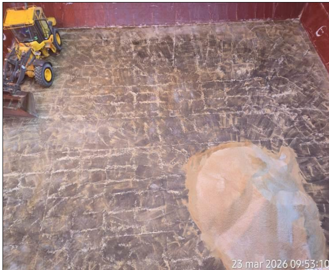
51. Operaciones de barrido al interior de la bodega 3.
