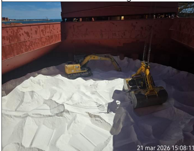
39. Retroexcavadora acopiando sal limpia al interior de bodega #4.
