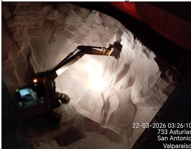
31. Retroexcavadora acopiando sal limpia al interior de bodega #2.
