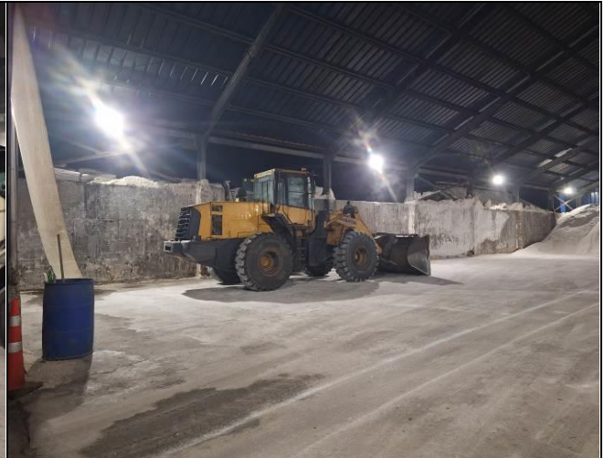
12. Cargador frontal acopiando sal al interior de bodega de acopio (Sal 12P), en complejo norte.
