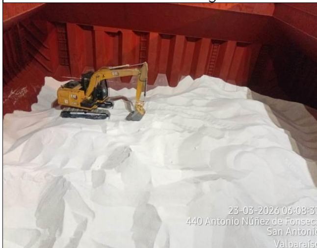
43. Retroexcavadora acopiando sal limpia al interior de bodega #5.
