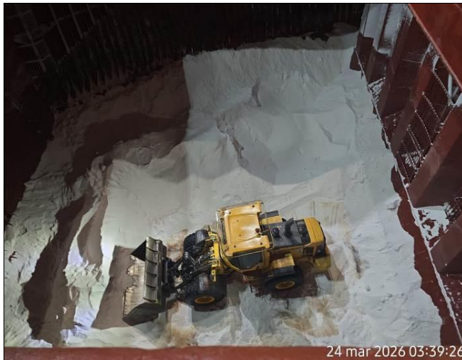
29. Cargador frontal acopiando sal limpia al interior de bodega #1.
