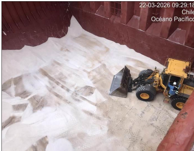
33. Cargador frontal acopiando sal limpia al interior de bodega #2.
