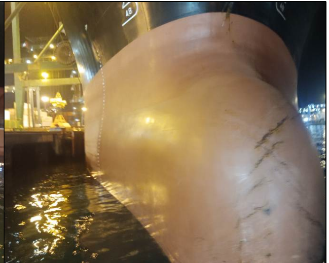
6. Lectura de calados final, proa estribor.
