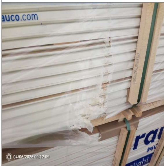
59.- Vista daño 1/2 tipo rasguño a 21 piezas en lote 3623206003.
