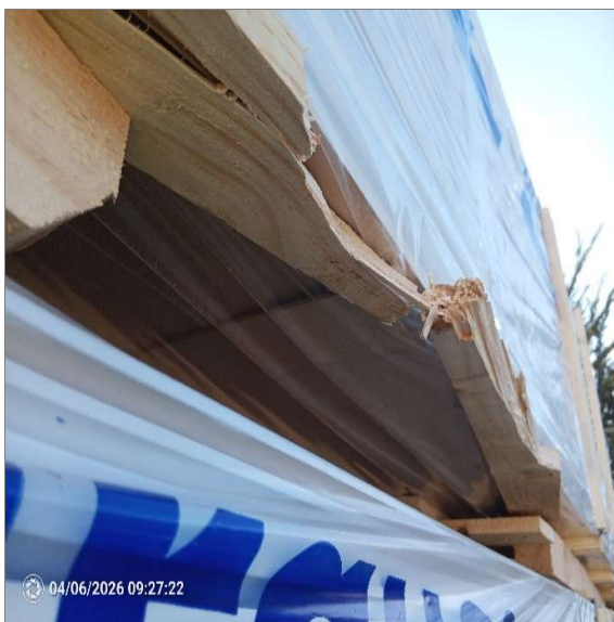
77.- Vista tabla basal quebrada en lote 3623205980.
