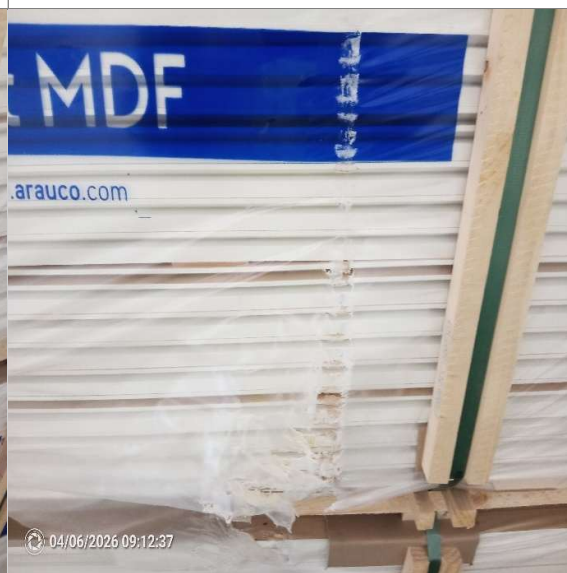
60.- Otra vista a daño 1/2 tipo rasguño a 21 piezas en lote 3623206003.
