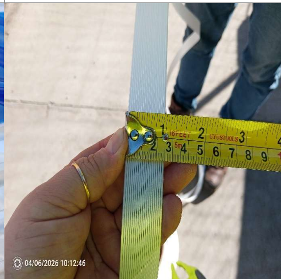
52.- Ancho cinta de trinca: 2,5 cm.
