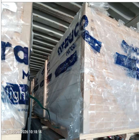
79.- Vista a zuncho cortado, tabla superior y lateral quebradas al chocar en travesaño de contenedor durante consolidado. En lote 3623209463.
