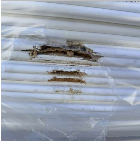
121.- Vista daño a 6 piezas en lote 3623206771.
