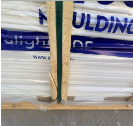
129.- Vista tabla lateral quebrada en lote 3623206744.
