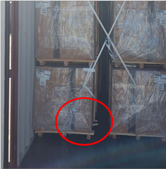
105.- Vista parrilla quebrada durante consolidado en lote 3623226257.
