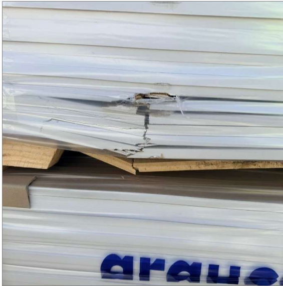
89.- Vista a 7 piezas dañadas y tabla basal quebrada en lote 3623220369.
