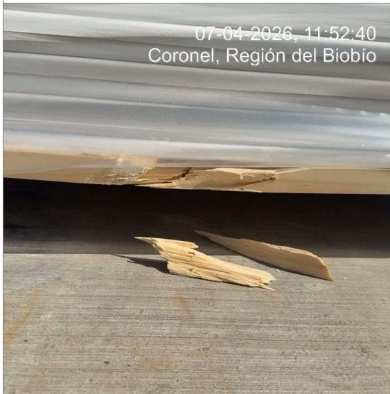
53.- Vista tabla basal quebrada en lote 3623221978.
