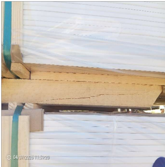
63.- Vista taco quebrado en lote 3623221684.
