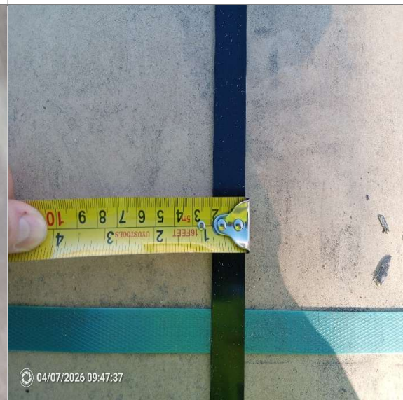
42.- Ancho zuncho metálico 2.0 cm.
