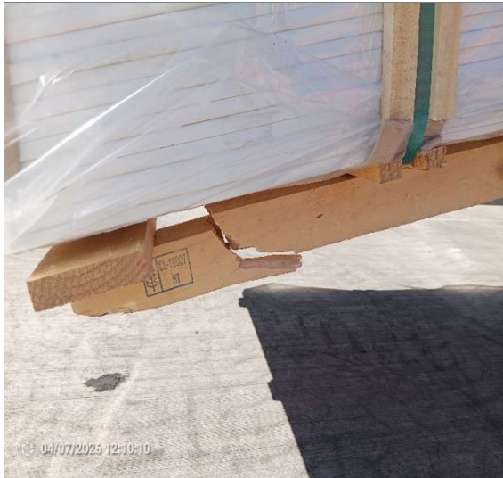
67.- Vista taco quebrado en lote 3623221689.
