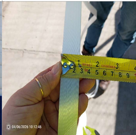
34.- Ancho cinta de trinca: 2,5 cm.
