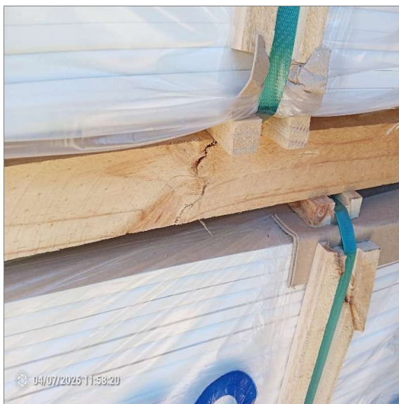
59.- Vista taco quebrado en lote 3623221903.
