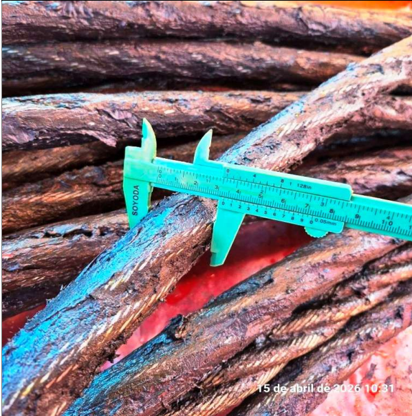
3. Vista diámetro nominal del cable virador dañado con 31,8mm.
