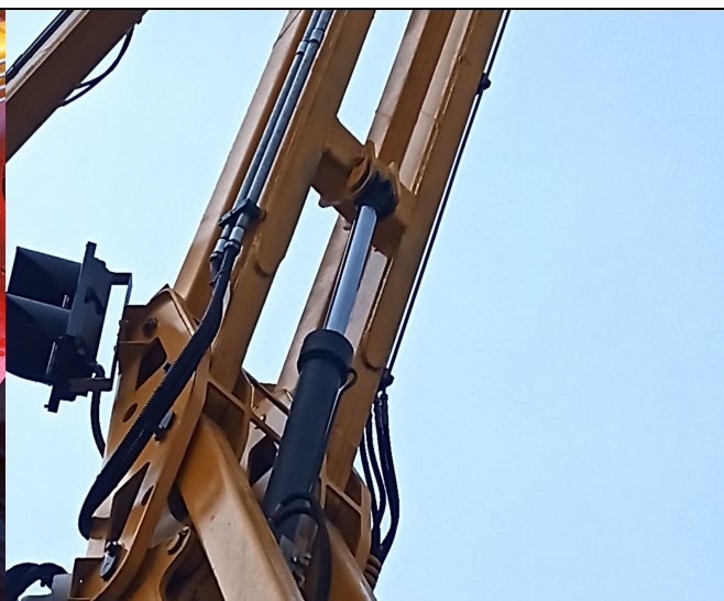
18.-Vista de cilindro de levante de Grúa.
