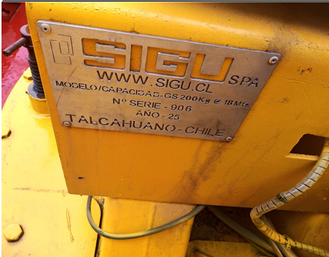
13.-Vista de placa con características de la Grúa.
