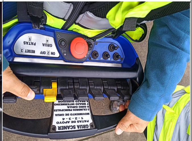
12.- Vista de controles a distancia de Grúa.
