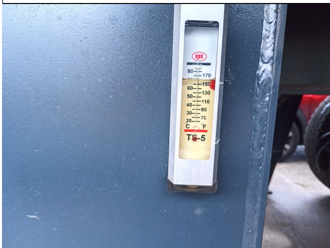
11.- Vista de nivel de hidráulico de la Grúa.
