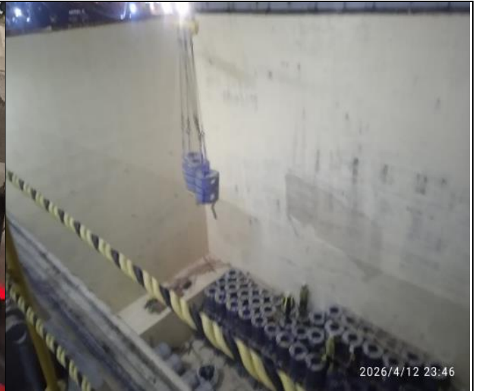
82. Bobinas paletizadas en proceso de descarga.
