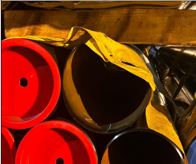
95. Atado de tubos deformado; No. P202511023 -bodega No. 6.
