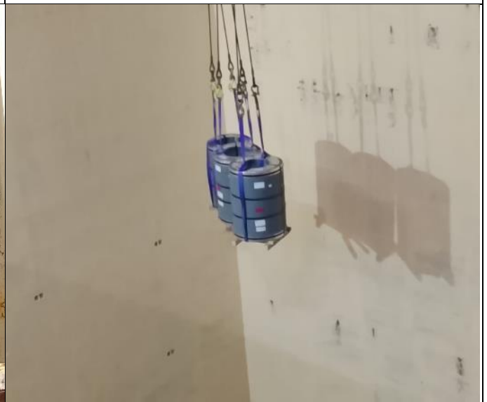
80. Bobinas paletizadas en proceso de descarga.
