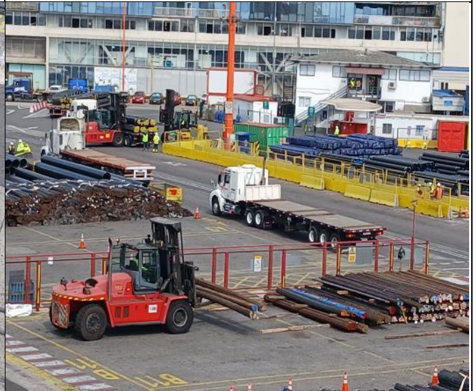
76. Grúa horquilla trasladando macizos a la zona de acopio.
