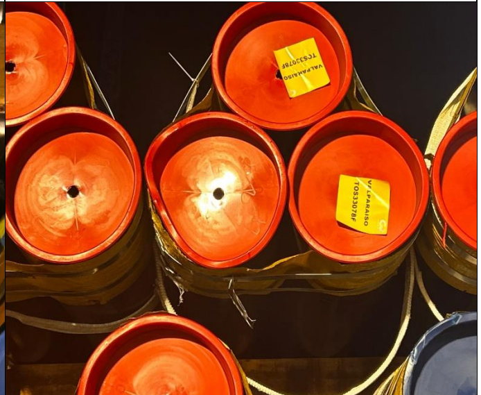
96. Atado de tubos deformado, No. TOS33078F- bodega No. 6.
