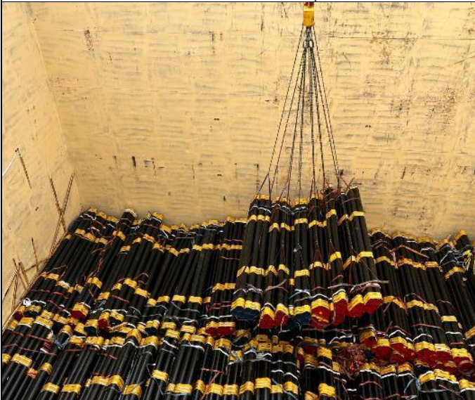
63. Paquetería de tubos en proceso de descarga desde bodega No. 6.
