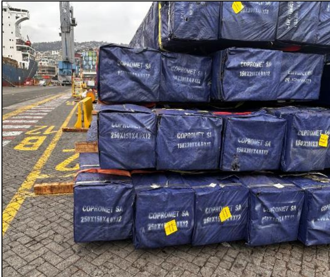
69. Paquetería de perfiles cuadrados acopiados en el muelle.
