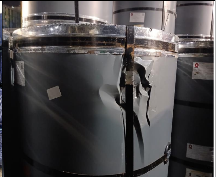
98. Bobina vertical paletizada con protección externa rasgada. No. 603C678604 -bodega No. 8
