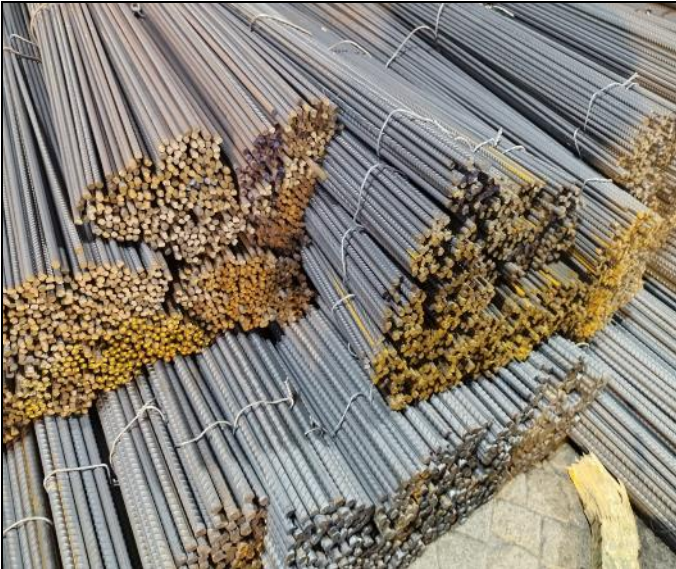
73. Vista de atados de alambrones de acero acopados y sin daños observables.
