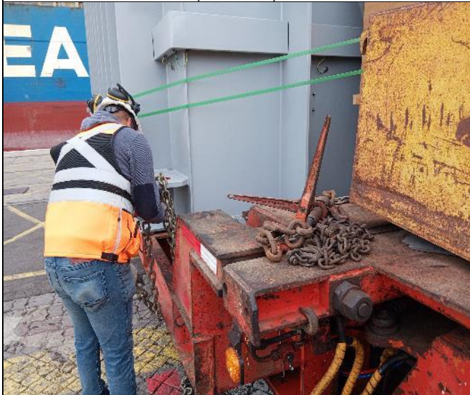
47. Transformador siendo trincado con cadenas.
