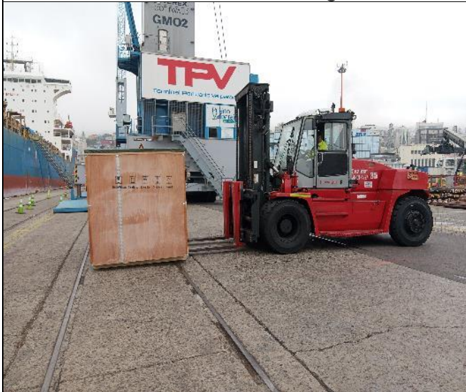
51. Grúa horquilla trasladando cajones a la zona de acopio.
