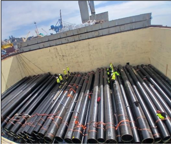
5. Condición de arribo bodega No. 6, paquetería de tubos varios, perfiles cuadrados y paquetería galvanizada.
