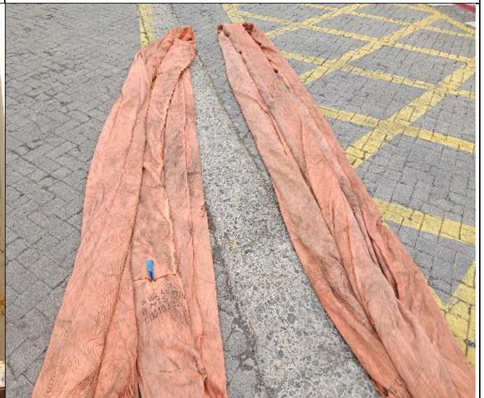
8. Eslingas sintéticas utilizadas para las diferentes cargas con capacidad de 40 ton.
